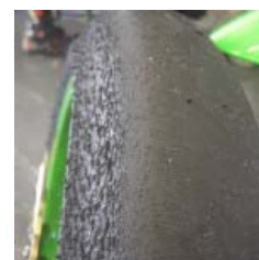
Usure due à un problème de géométrie
