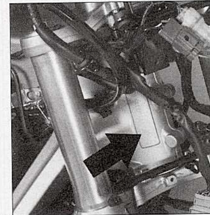
Emplacement du numéro de série du cadre sur la droite de la colonne de direction.
